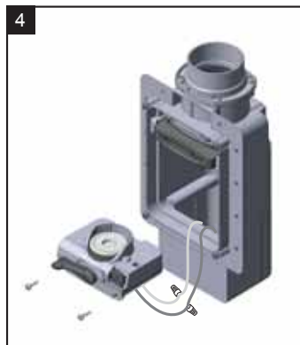
4 Csatlakoztassa a szerelőlap alsó modulján található két érintkező vezetékét a rendszer vezérlőhálózati kábeléhez, és csavarozza a helyére az alsó modult.
